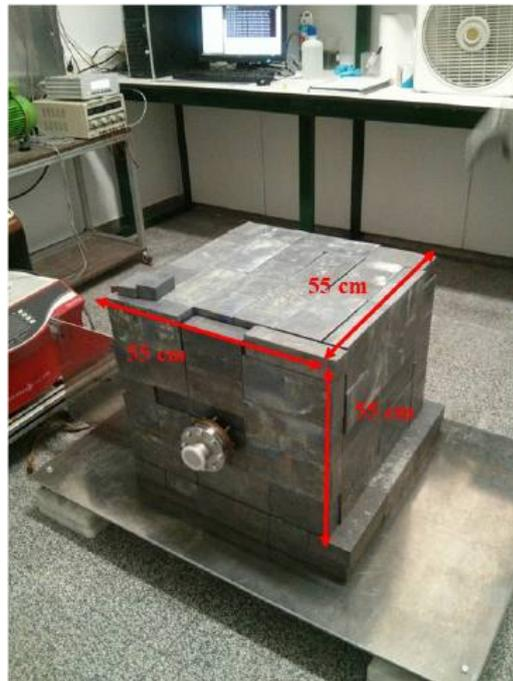
Рисунок 4.4 — Детекторная система IAXO-D0 пассивной свинцовой защите [149].
