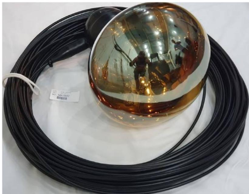
Рисунок 3.2 — Фотоумножитель R7081-100 WA-S70 прототипов ББНТ.
