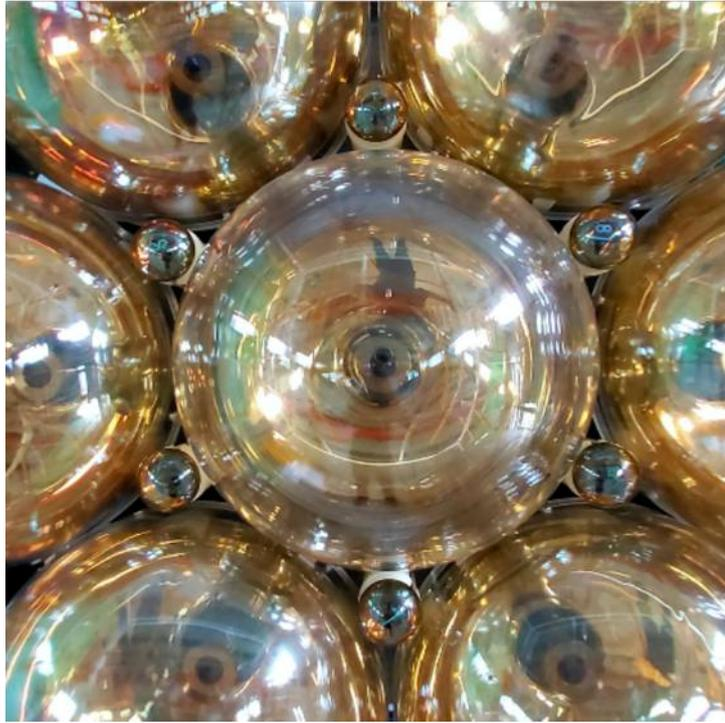
Рисунок 2.5 — Взаимное расположение 20- и 3-дюймовых ФЭУ.
