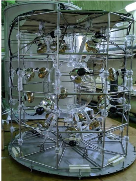
Рисунок 3.4 — Акриловая сфера для жидкого сцинтиллятора и фотоумножителя R7081-100 WA-S70, установленные на каркасе, полутонного прототипа ББНТ.
