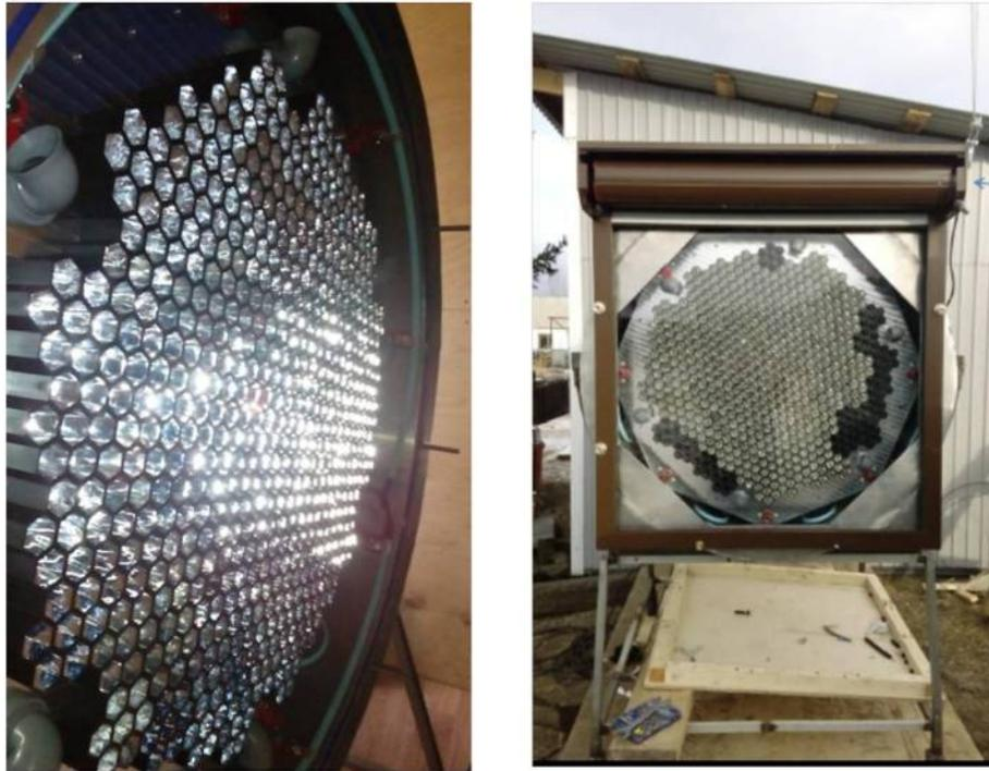
Рисунок 1.26 — Камера изображения первого телескопа TAIGA-IACST.
