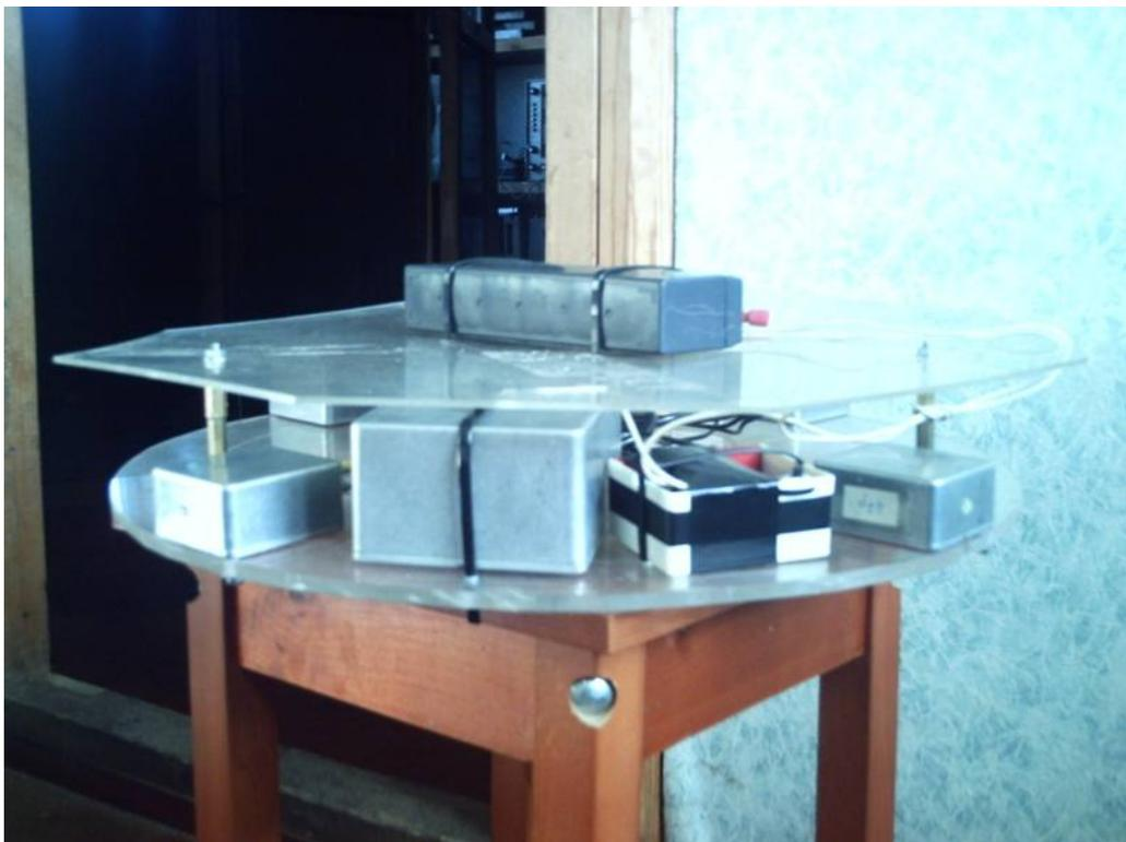
Рисунок 1.9 — Фотография «кругового» наносекундного источника световых импульсов на базе светодиодов высокой мощности [47].
