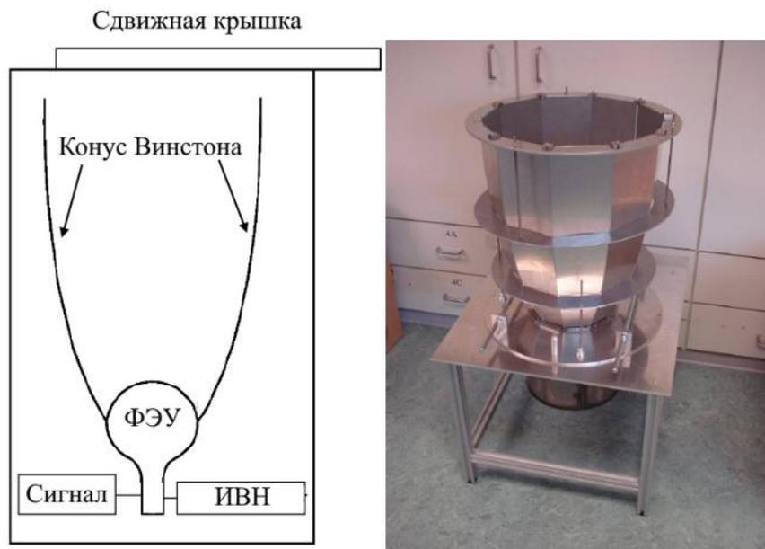
Рисунок 1.11 — Конус Винстона для установки TAIGA-HiSCORE.
