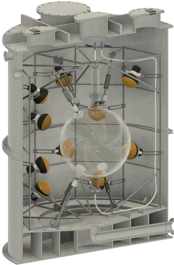
Рисунок 3.1 — Модель полутонного прототипа ББНТ.
