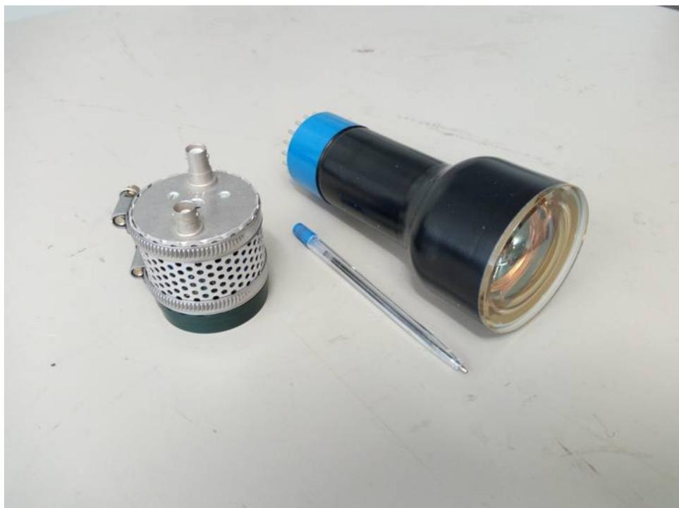
Рисунок 4.6 — Фотоумножитель ХР2312В и его делитель напряжения питания.
