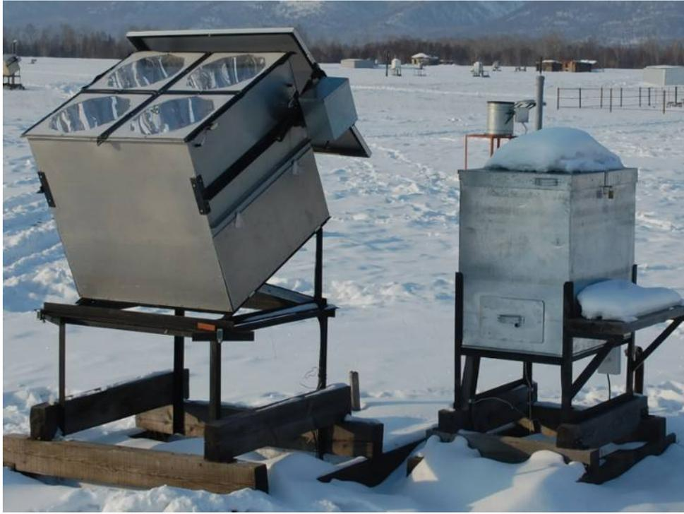
Рисунок 1.10 — Оптический модуль установки TAIGA-HiSCORE в открытом положении и модуль электроники.
