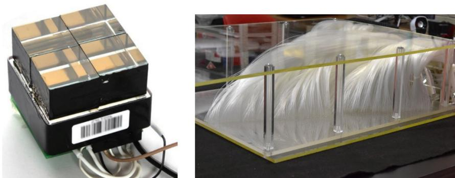
Рисунок 17. Фотографии базовых элементов макета детектора FIT: черенковский модуль T0+ и сектор сцинтилляционного детектора V0+
