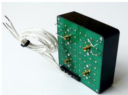
Рисунок 11. Фотография МКП-ФЭУ семейства Planacon, оптимизированного для использования в детекторе FIT.
