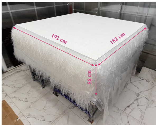
Рис. 5 — 56 плоскостей 192 \times 182 \text{ см}^2 детектора СуперFGD, собранные с использованием калиброванной лески диаметром 1.3 мм. На этапе подготовки СуперFGD к установке в ND280 леска была заменена на WLS оптоволокна [24].
