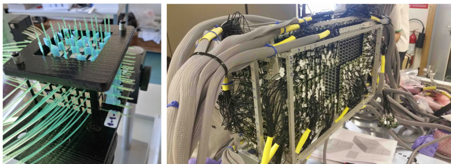
Рис. 6 — Слева: первый прототип СуперFGD ( 5 \times 5 \times 5 см 3 ) с установленными WLS волокнами [27]. Справа: вид снизу частично инструментированного второго прототипа СуперFGD ( 24 \times 8 \times 48 см 3 ) [28].
