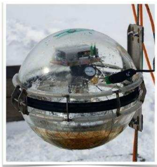
Рисунок 2.3 — Крепление глубоководного модуля на нержавеющей кабель-трос с помощью рамы .
