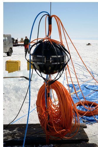
а) Модуль секции, установленный на гирлянде
