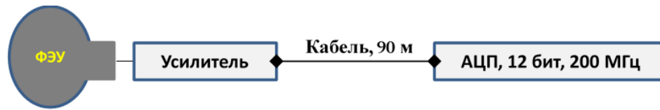
Рисунок 4.1 — Измерительный канал Baikal-GVD
