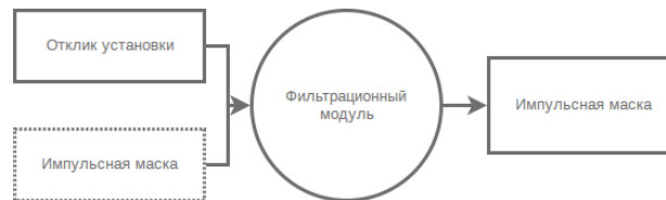
Рисунок 4.20 — Схема работы модуля фильтрации данных Baikal-GVD
