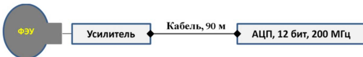
Рис. 8. Измерительный канал
