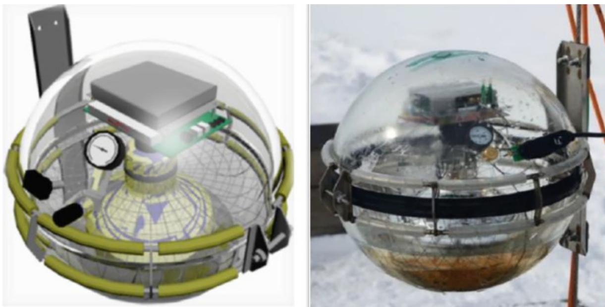
Рис.3. Оптический модуль Baikal-GVD
