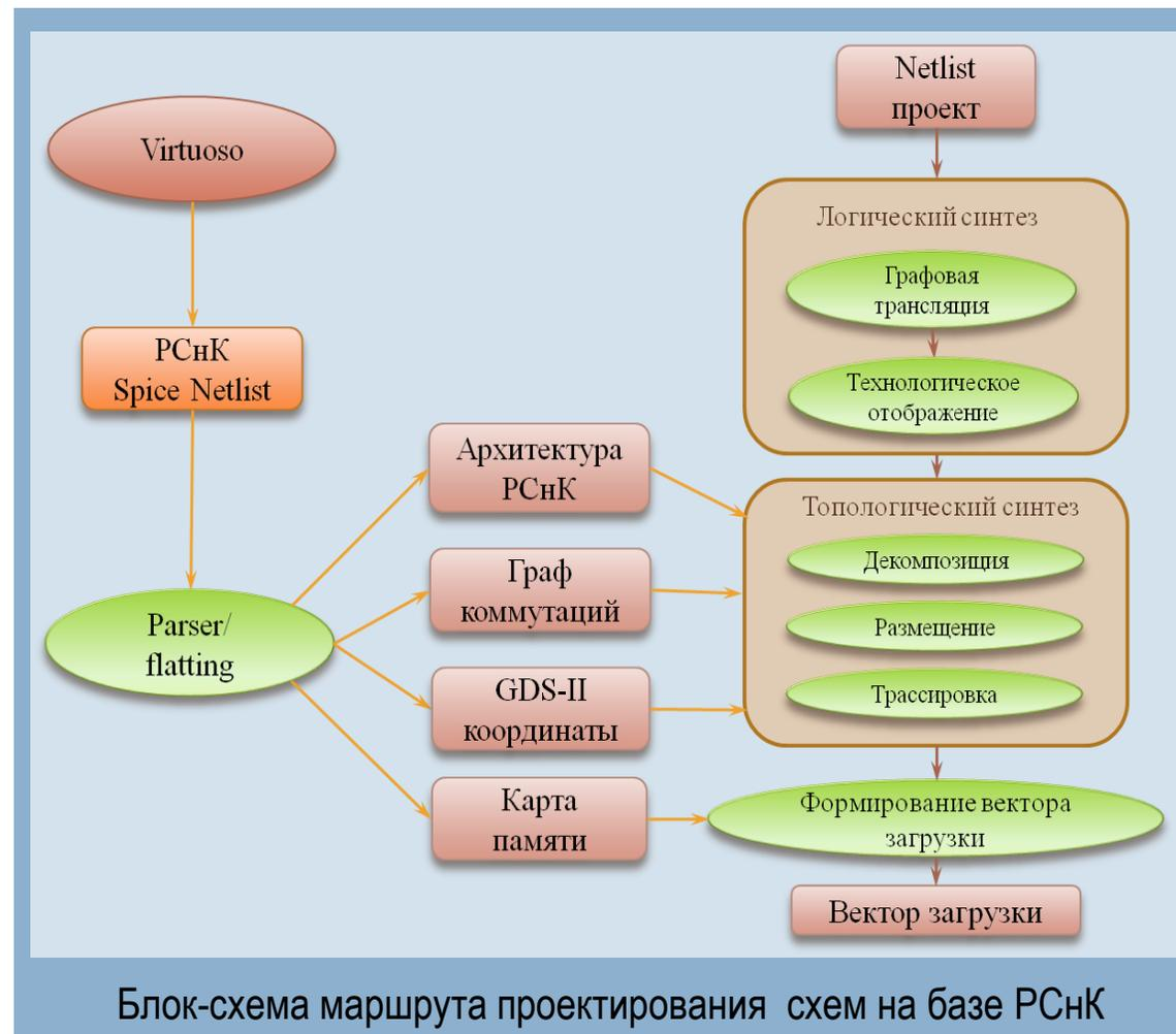
Блок-схема маршрута проектирования схем на базе РСнК
