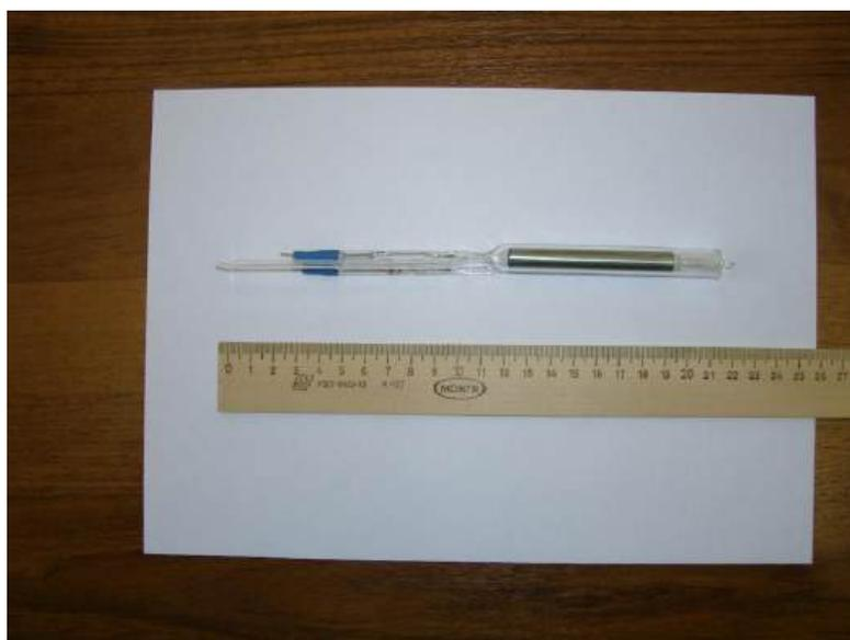
Рисунок 5.4 – Нейтронный счётчик для сверхвысоких нейтронных потоков
