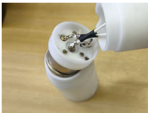
Рисунок 18.3 — Узел ввода детектора в сверхпроводящий соленоид, в центре SHV-разъём для вывода сигналов детектора, слева разъём типа ШР для вывода сигналов датчиков температуры и магнитного поля, в центре и слева вакуумные разъёмы для откачки
