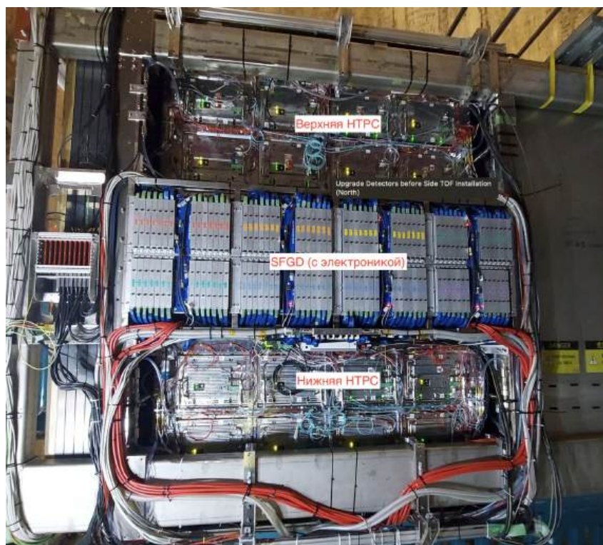
Рисунок 6.1 — Обновленный ближний детектор ND280 после установки активного нейтринного детектора SFGD, двух горизонтальных времяпроекционных камер НТРС, пяти панелей времяпролетного детектора ТоF, а также калибровочных систем, электроники и кабелей в магните ND280 (перед установкой шестой панели ТоF и закрытием всей системы)
