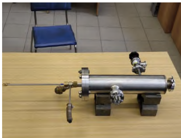
Рисунок 18.4 — Узел ввода детектора в сверхпроводящий соленоид, в центре SHV-разъём для вывода сигналов детектора, слева разъём типа ШР для вывода сигналов датчиков температуры и магнитного поля, в центре и слева вакуумные разъёмы для откачки
