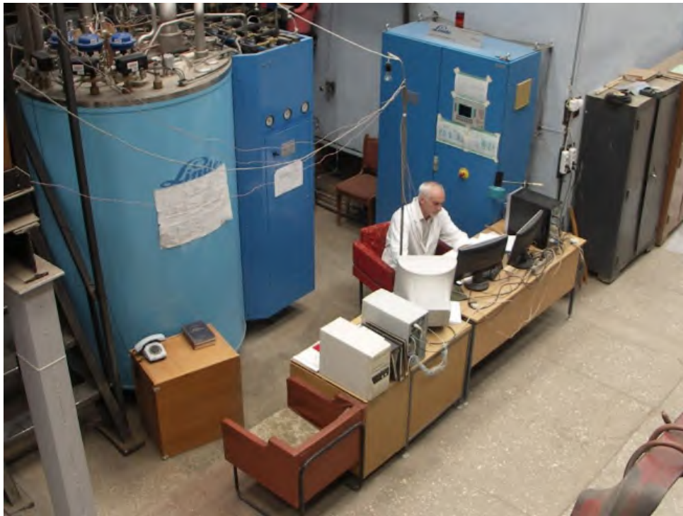
Рисунок 9.3 — Фотография части криогенной системы установки с гелиевым ожижителем LINDE-50
