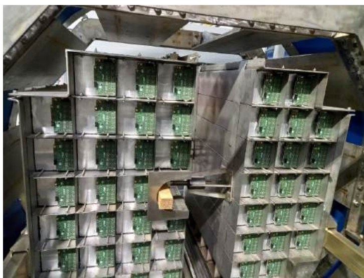
Рисунок 28 – Фото адронного калориметра с задней стороны. Видны электронные платы, установленные в торцах модулей
