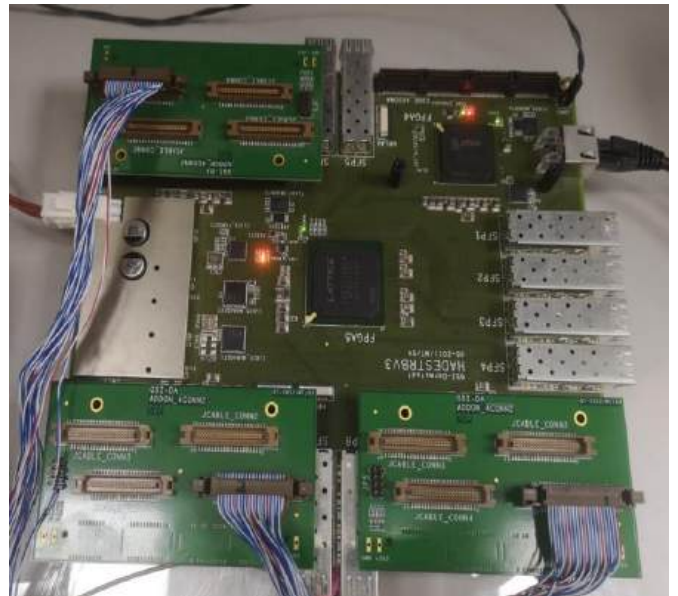
Рисунок 51 – Электроника считывания в двух вариантах исполнения для подключений к различным детекторам (слева), и модуль оцифровки (справа) на 128 каналов с разрешением 10 пс на отсчет
