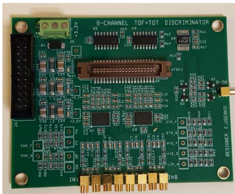
Рисунок 50 – Многофункциональная электроника считывания для времяпролетных камер RPC и электромагнитного калориметра ECaL с дополнительными функциями и возможностями для изучения параметров TOT метода с различными камерами
