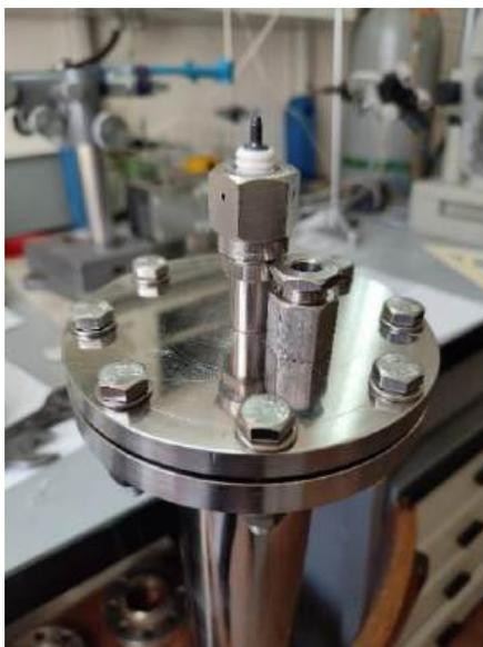
Рисунок 12.5 – Фланец с установленной крышкой и герметично присоединенный токоввод
