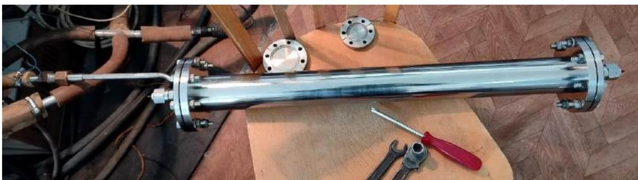
Рисунок 12.6 – Счетчик в сборе в процессе откачки и проверки на герметичность
