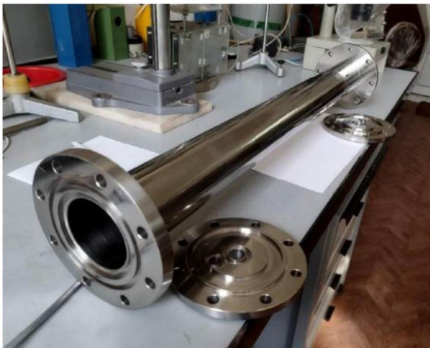
Рисунок 12.3 – Корпус счетчика с приваренными фланцами и снятыми крышками
