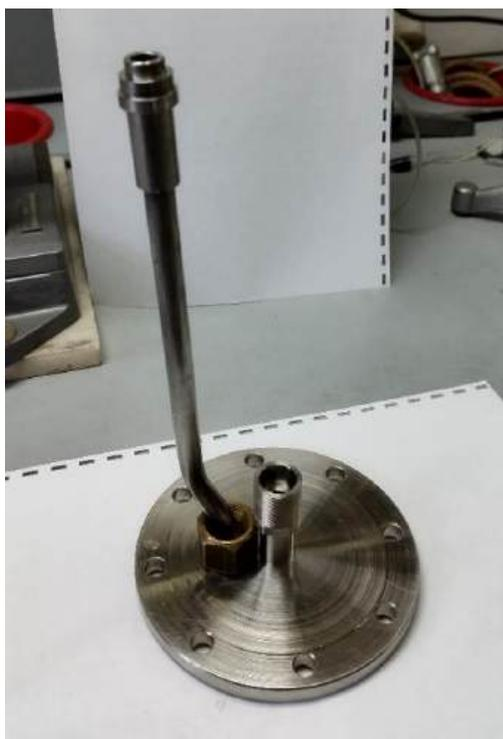
Рисунок 12.4 – Крышка счетчика с приваренными патрубком токоввода и штуцером газовой линии
