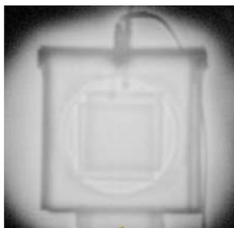
Рисунок 6.2 – Проекция Черенковского монитора, полученного средствами протонной радиографии
