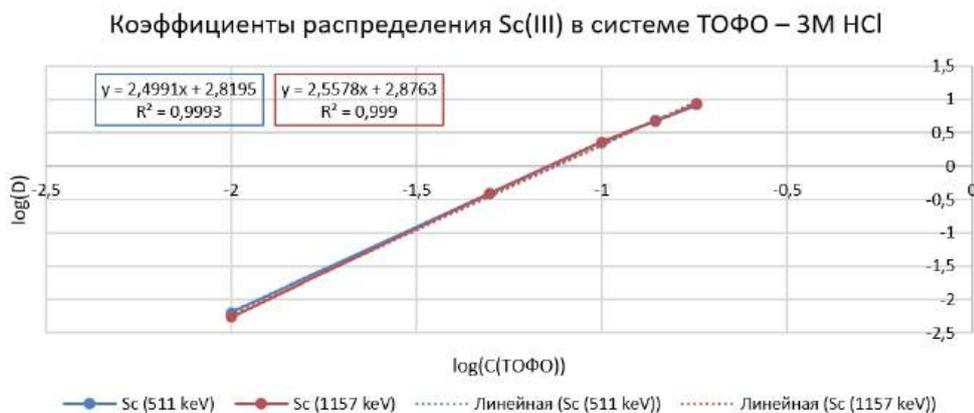
Рисунок 3.10 – Коэффициенты распределения Sc(III) в ТОФО при экстракции из 3 М HCl в зависимости от концентрации ТОФО
