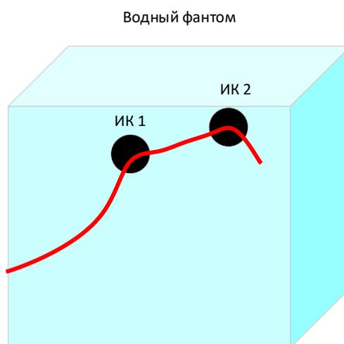
Рисунок 6.4 – Схематическое изображение предложенной методики калибровки гребенчатого фильтра по двум ионизационным камерам
