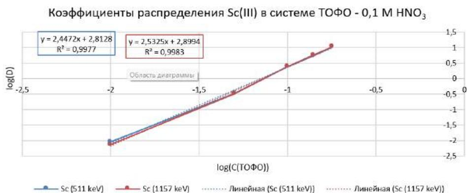
Рисунок 3.8 – Коэффициенты распределения Sc(III) в ТОФО при экстракции из 0,1 М HNO<sub>3</sub> в зависимости от концентрации ТОФО
