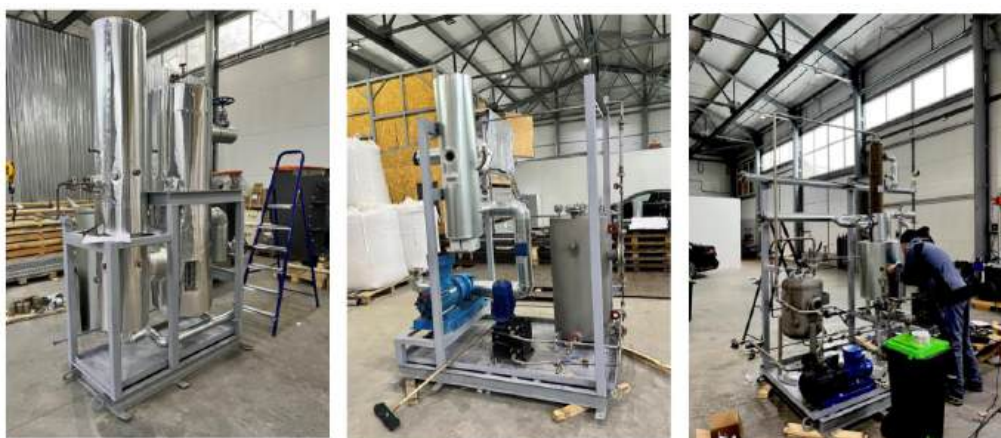
Рисунок 19 – Слева: вакуум-выпарная колонна с падающей пленкой VS-01 и промывная колонна VS-01. В центре: охладитель неконденсированных паров и сборник технического конденсата. Справа: емкость исходного раствора и термомасляный котел
