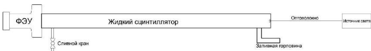
Рисунок 21 – Схема измерительной установки для изучения процессов ослабления сцинтилляционного излучения в жидких сцинтилляторах
