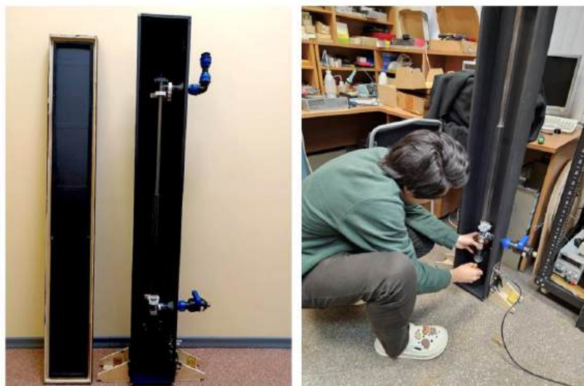
Рисунок 23 – Фотографии измерительной установки для изучения процессов ослабления сцинтилляционного излучения в жидких сцинтилляторах
