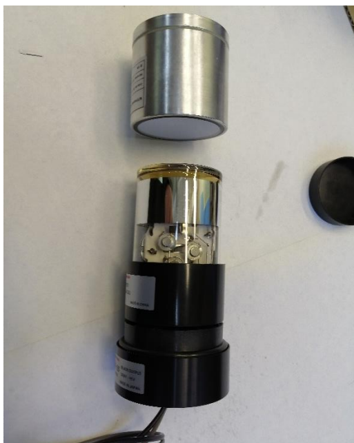
Рис. 2.8. Фотография детектора рассеянных фотонов. Слева – компоненты детектора: сцинтиллятор NaI(Tl) и ФЭУ Hamamatsu PMT R6231. Справа – сцинтилляционный детектор в сборе.
