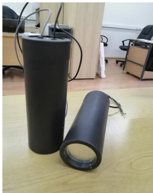
Рис. 2.8. Фотография детектора рассеянных фотонов. Слева – компоненты детектора: сцинтиллятор NaI(Tl) и ФЭУ Hamamatsu PMT R6231. Справа – сцинтилляционный детектор в сборе.
