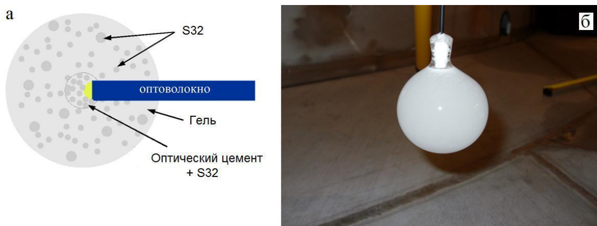
Рис. 7. Эскиз (а) и фотография (б) диффузного рассеивателя света калибровочной системы черенковского детектора мюонного вето эксперимента GERDA.
