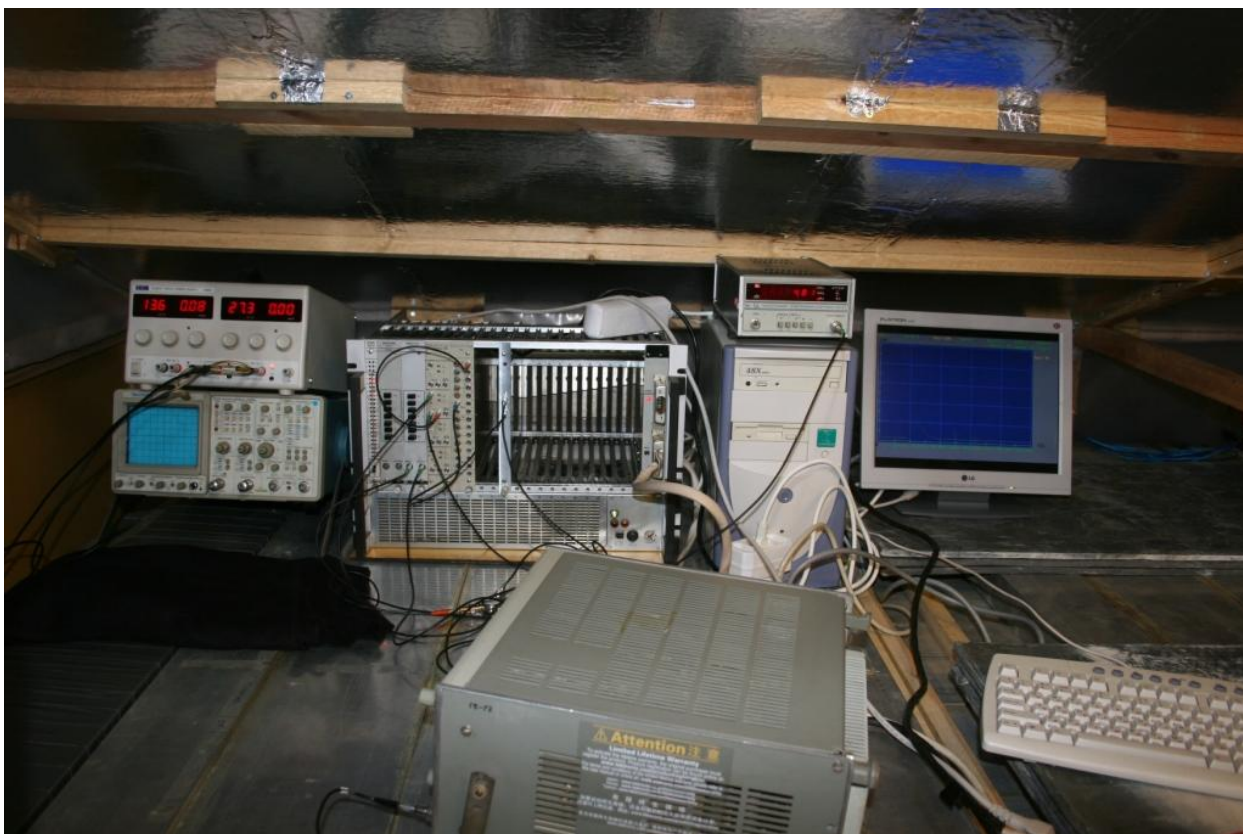
Рис. 43. Фотография измерительной установки с сцинтилляционным счетчиком SC1 в подземной лаборатории Центра подземной физики CUPP в шахте Пихасалми.
