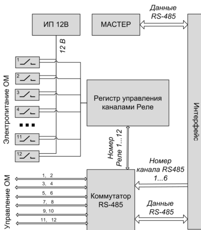
Рисунок 2.2.10. Функциональная схема блока управления ОМ
