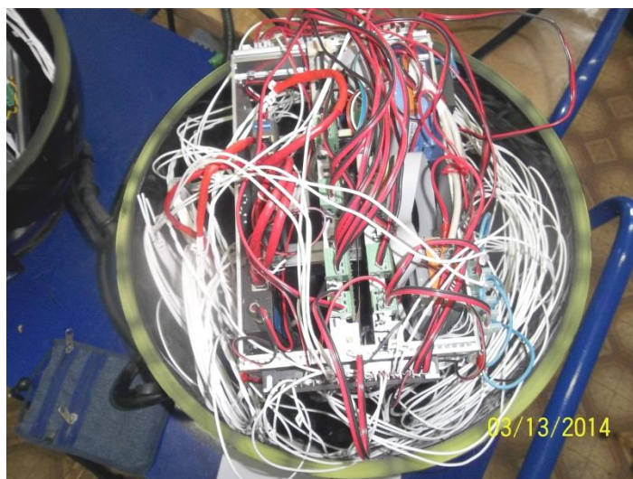
Рисунок 2.4.4. Модуль электропитания центра кластера в глубоководном корпусе
