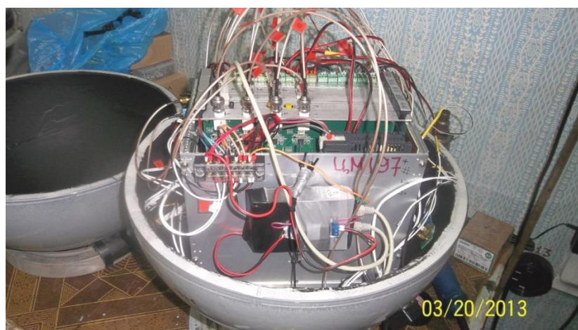
Рисунок 2.2.4. Крейт с электроникой ЦМ, установленный в глубоководный корпус
