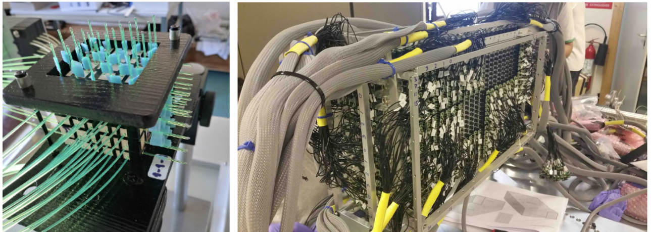
Рисунок 4.1 — Слева: первый прототип СуперFGD ( 5 \times 5 \times 5 \text{ см}^3 ) с установленными WLS волокнами [105]. Справа: вид снизу частично инструментированного второго прототипа СуперFGD ( 24 \times 8 \times 48 \text{ см}^3 ) [111].
