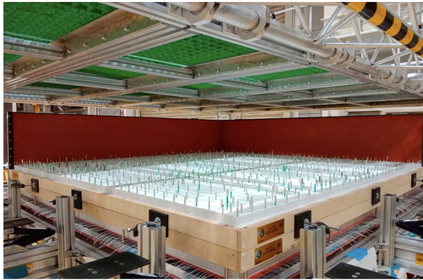
Рисунок 5.10 — Промежуточный результат укладки слоев кубических сцинтилляторов на нижней панели механического контейнера СуперFGD с использованием вертикальных стоп-панелей и набора стальных спиц диаметром 1.3 мм [107].
