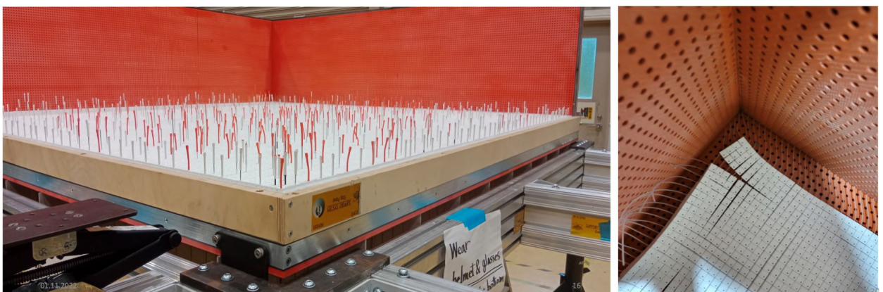
Рисунок 5.9 — Слева: Первые несколько слоев кубических сцинтилляторов, сложенные друг на друга и зафиксированные с помощью вертикальных стоп-панелей и набора стальных спиц. Справа: Первый слой СуперFGD в процессе его укладки на нижнюю панель механического контейнера [107].
