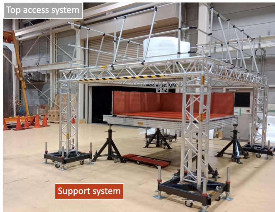
Рисунок 5.7 — Платформа для сборки СуперFGD: система верхнего доступа и опорная система [107].
