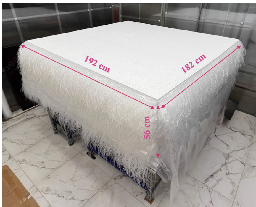
Рисунок 3.3 — 56 плоскостей 192 \times 182 см 2 детектора СуперFGD, собранные с использованием калиброванной лески диаметром 1.3 мм. На этапе подготовки СуперFGD к установке в ND280 леска была заменена на WLS оптоволокна [107].
