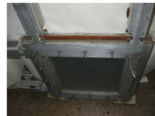
Рис 14. Двухкоординатная пропорциональная камера с чувствительной областью 400 × 400 мм<sup>2</sup> в собранном виде
