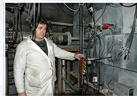
Подготовка к измерениям на спектрометре по времени замедления в свинце (СВЗ-100). А.А. Алексеев
