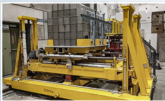
Модернизированный калориметр ИЯИ РАН установки NA61/SHINE с отверстием для прохождения пучка. На заднем плане виден новый дополнительный калориметр, перекрывающий область пучка
