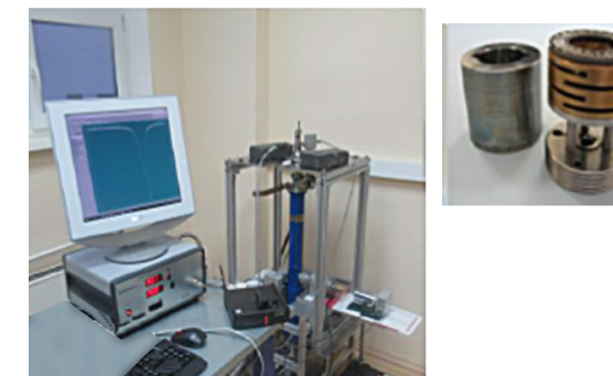
Лабораторная установка для рентгеновской дифракции под давлением (слева). Мессбауэровский спектрометр с криосистемой (справа)
