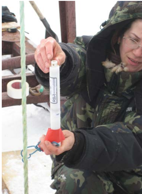
Рисунок 2.9.1.3. Установка глубоководного измерителя температуры воды TR-1060 на буйковой станции «Молодежная»
