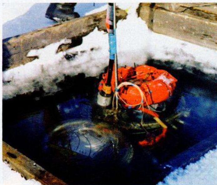
Монтаж гирлянды оптических модулей первого в мире глубоководного нейтринного телескопа НТ-200 на Байкале
